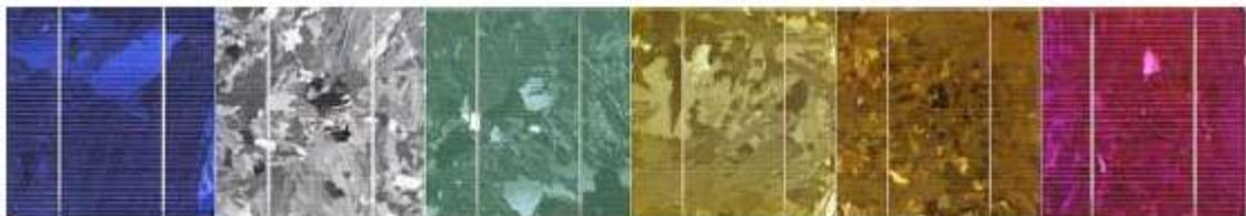
*Figura 3.7 Palette di Colori per pannelli fotovoltaici di tipo policristallino [29]*
